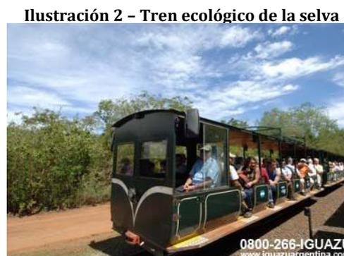
Tiene una capacidad para 120 viajeros y su recorrido es de siete kilómetros. Fue construido en Inglaterra en los talleres de la empresa Alan Keef, pintado totalmente de verde, se compone de una locomotora a gas que arrastra cuatro vagones techados, con asientos de madera y totalmente abiertos hacia el exterior, para que el visitante se mantenga en directo contacto con la selva.
