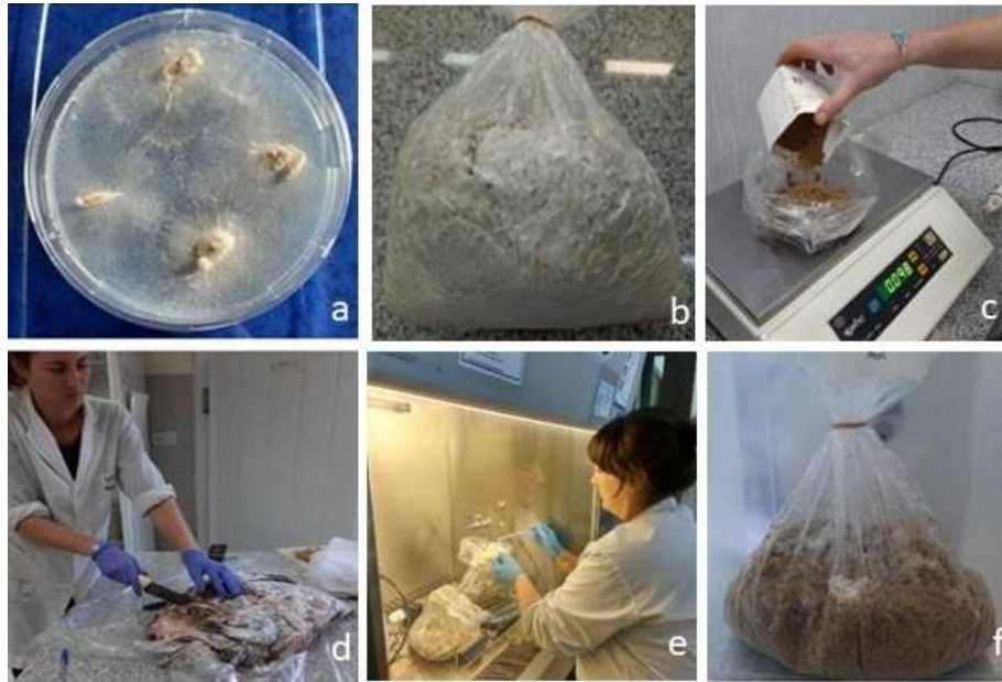
Fig 1. Etapas para el desarrollo del micelio. a) Inóculo primario, b) inóculo secundario, c) Preparación del sustrato, pesaje de pellet de trigo, d) Tratamiento del residuo de la industria pesquera, e) inoculación del sustrato con el hongo y f) Sustrato inoculado.
